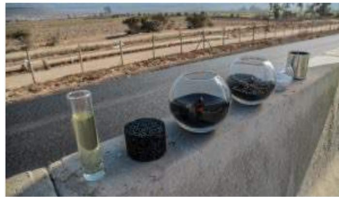
Reutilización de polvo de neumático para uso en plantas de asfalto para carreteras, mejoran la durabilidad del asfalto y reducen la contaminación acústica
